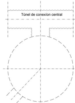
TERMINACIÓN DE LA EXCAVACIÓN DE LA CÚPULA SE INSTALARAN: - CS1: PERNOS DYWIDAG R38-420 - L=10.0m @ 2.0x2.0m, - CS2: PERNOS DYWIDAG R38-420 - L=10.0m @ 2.0x2.0m, - CS3: PERNOS DYWIDAG R38-420 - L=12.0m @ 1.50x1.50m, Y HORMIGÓN PROYECTADO (30cm), LOS PRIMEROS 5cm CON FIBRAS DOBLE MALLA DE ARMADURA @8 150x150mm
